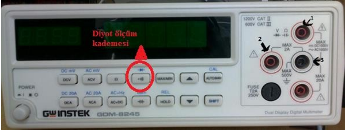
Şekil 3. Multimetrede diyot ölçüm kademesi
